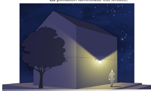
Éclairage moyen : le flux est majoritairement dirigé vers le bas mais une partie importante de celui-ci dépasse le plan horizontal. La pollution lumineuse est importante.
